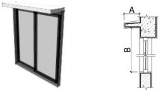
图 D.0.1-1 水平遮阳的特征值的示意图
